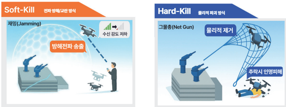
(그림 2-26) 소프트킬(왼쪽) 방식과 하드킬(오른쪽) 방식의 차이
